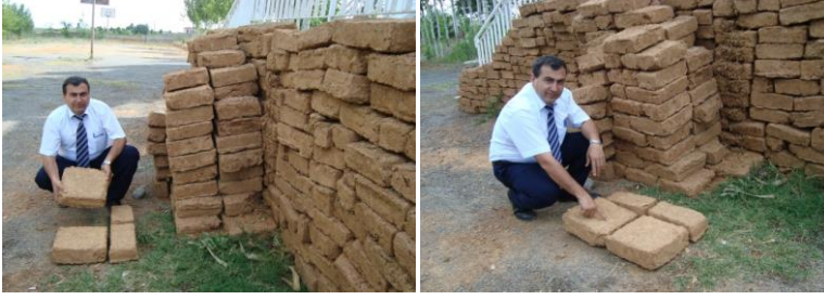
Görsel 1: Kerpiç malzemeler ana ve kuzu olarak iki tipte üretilirler.
