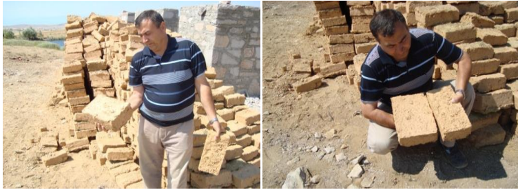
Görsel 13: Kerpiç malzemeler çevre etkisine maruz bırakılırsa bozulurlar.
