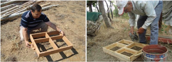
Görsel 3: Kerpiç kalıplarında ana ve kuzular aynı anda dökülürler.
